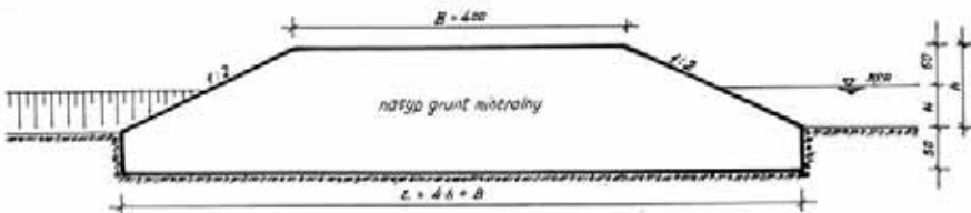
Rys. 15. Przekrój poprzeczny grobli ziemnej na rowie zbiorczym odprowadzającym wodę z torfowiska Sołtysek wg projektu Włodzimierza Stepaniuka.
