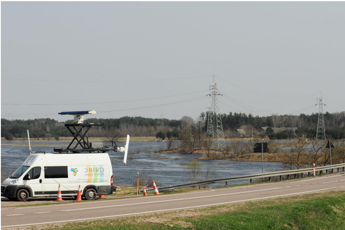
Ryc. 3.3. Radar ornitologiczny 3 Bird Radar System na badanej powierzchni
