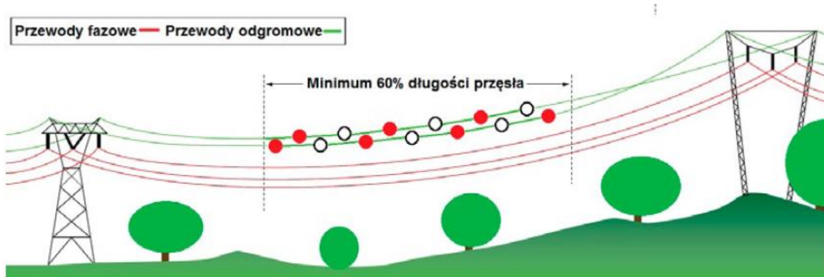
Sposób rozmieszczenia kul – widok z boku (na podstawie APLIC 2012). Placement of sign spheres – side view (after APLIC 2012).
